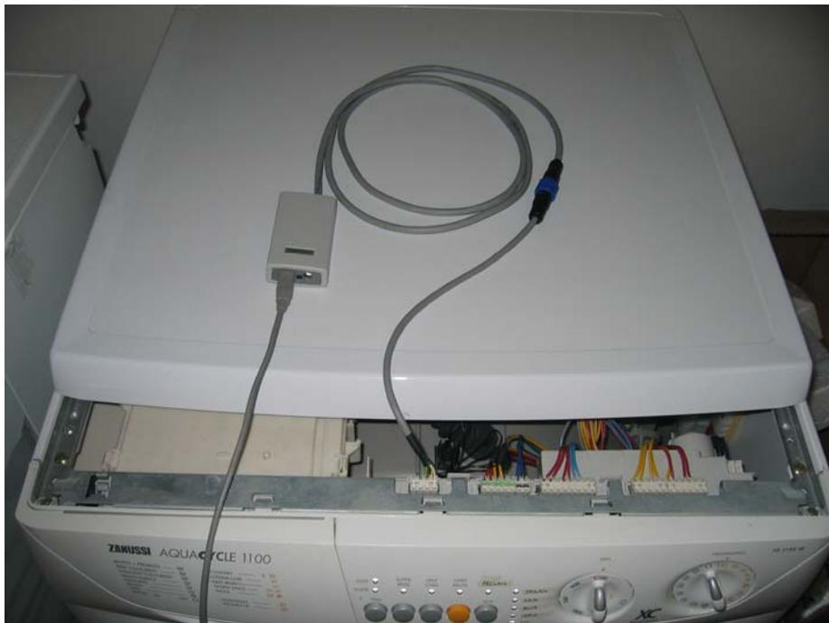
*Fig. 11. Gerät verbunden mit AMI-Modul*
